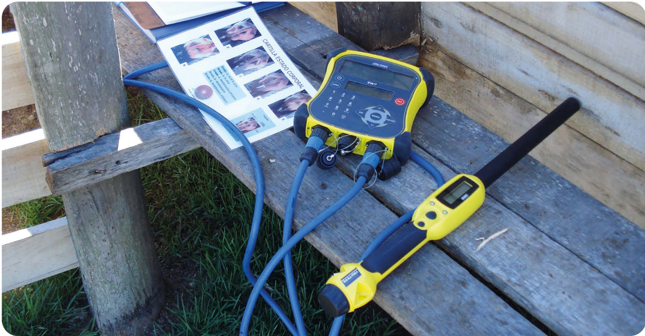
Integración de medidas de bajo costo para el apoyo a la toma de decisiones: lectura de caravana, pesaje y cuantificación de condición corporal. Permiten decidir manejos sobre el rodeo de cría. Foto: INIA.
